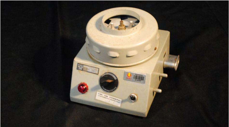
O Agitador Orbital Universal modelo nº 69864 foi fabricado pela LaborStirrer. O MUVIe possui um equipamento que apresenta 21 cm de altura, 17 cm de largura, 16 cm de profundidade e peso de 3 Kg. Atualmente os modelos encontrados diferem bastante deste; sua aplicação permite homogeneizar soluções reagentes utilizadas em investigações científicas, laboratórios físicos, químicos e análises industriais. Este equipamento está na FURG desde 01/01/1970.
