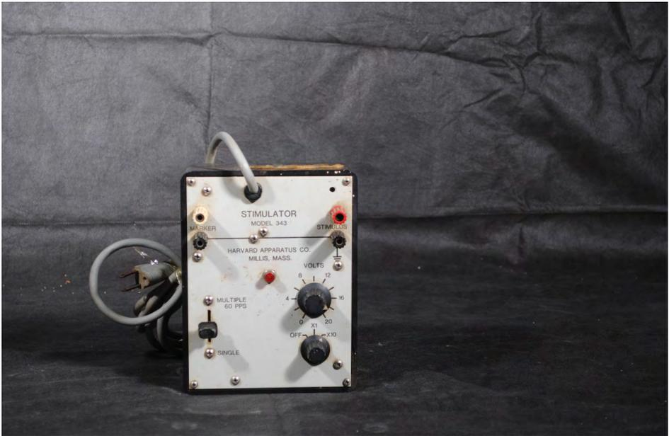
O estimulador elétrico HARVARD APPARATUS, Modelo 343 do acervo do MUVIE possui 17 cm de altura, 13 cm de largura, 6 cm de profundidade e pesa 1,4kg. Era utilizado para produzir estímulos elétricos em práticas de fisiologia muscular e neurofisiologia. Atualmente, a Harvard Apparatus não fabrica mais esse modelo, porém, ele ainda é referência em equipamentos eletrônicos biomédicos para pesquisa e ensino. Este equipamento está na FURG desde 01/01/1970.
