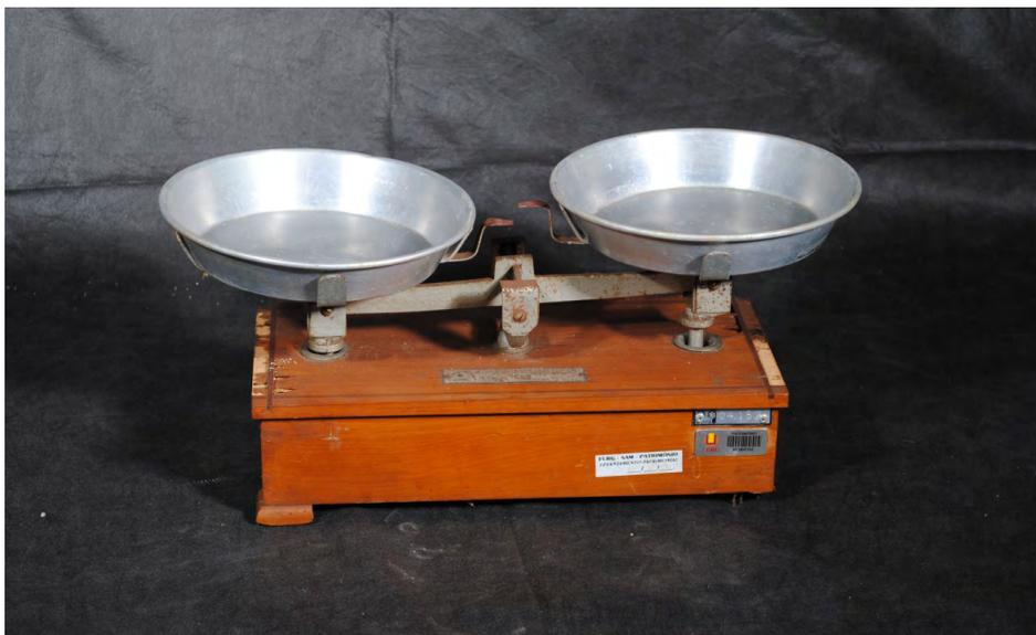
A Balança mecânica que compõe o acervo do MUVIe foi construída em uma base composta por: uma caixa de madeira, com gaveta envernizada, estrutura de metal cromado e pratos de aço inox. O equipamento mede 4 cm de altura, 32 cm de largura e pesa 1,797kg. A função exercida por este equipamento era pesar reagentes químicos para as aulas, ração para animais e outros itens de uso para as práticas, utilizados em pesquisa científica. Este equipamento está na FURG desde 01/01/1970.
