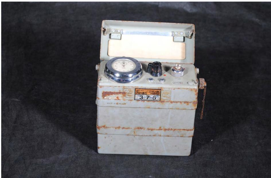
O contador Geiger é de origem Húngara e tem 17 cm de largura, 8cm de profundidade, 18cm de altura e 2,866Kg de peso. Este equipamento foi inventado pelo físico Johannes Hans Geiger, em 1908, para medir os níveis de radiação em corpos e no ambiente. É composto por um tubo com argônio, que é ionizado ao ser atravessado por partículas alfa e beta da radiação. Usado como equipamento de proteção e análise de radiação ambiental, por exemplo, em locais com suspeita de acidentes nucleares.
