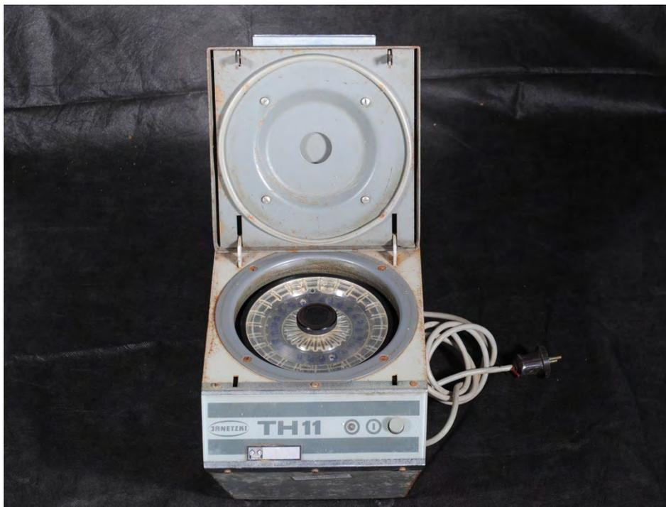
A centrífuga de microtubos da marca Heinz Jane Tkzi, do acervo do MUVIe, tem 19,5 cm de largura, 26 cm de profundidade e 21cm de altura e pesa 7, 100Kg. Este equipamento era utilizado para centrifugação rápida de amostras, separando fases da mistura. Era usada para o preparo de amostras de aula prática ou da pesquisa. Este equipamento está na FURG desde 01/01/1970.
