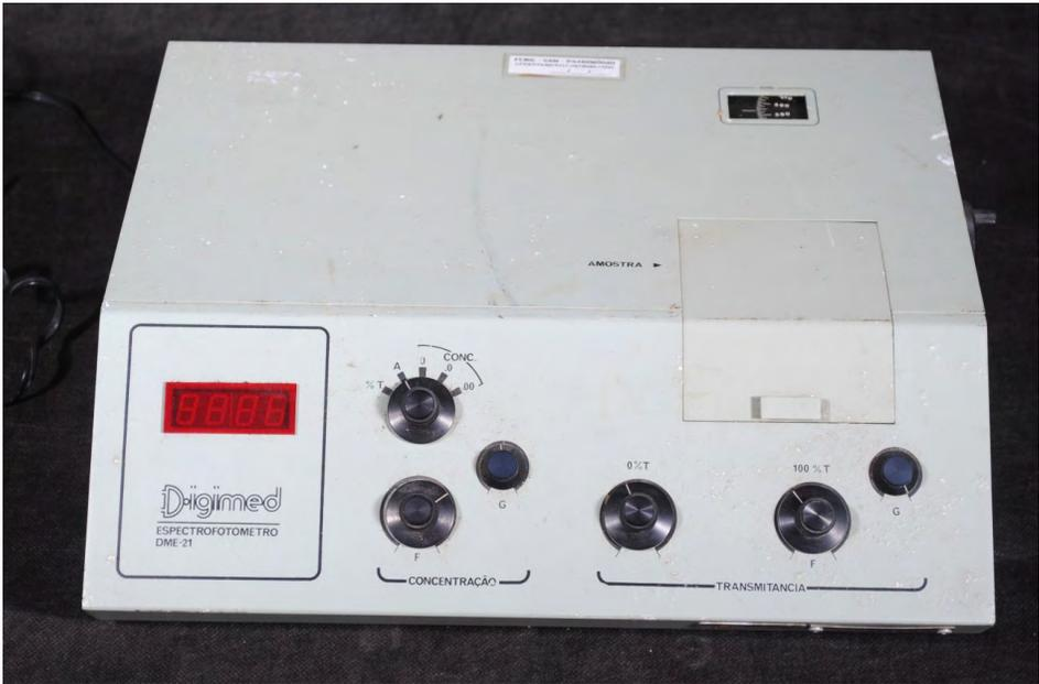
O equipamento registrado no acervo MUVie é do modelo DME21, série 9027, luz visível, digital, da marca Digimed; mede 10 cm de altura, 38 cm de largura, 33 cm de profundidade e pesa 5,600 Kg. Para detalhes, ver 6.1 Espectrofotômetro MUVie EQC065 FURG 35687. Este equipamento está na FURG desde 31/08/1992.
